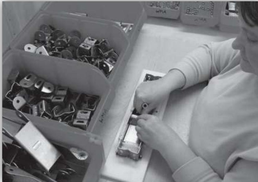
Eine Antennenhalterung montieren
